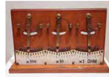
Upornik z upori 100, 10 in 1 Ohm, 20. stoletje Gimnazija in srednja šola Kočevje v 32,8 š 52,5 g 14,1 kovina, les
